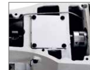
zamknięty system olejowy
