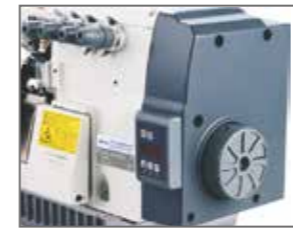
zintegrowany silnik Direct Drive
