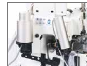
opcjonalnie elektromagnetyczne podnoszenie stopki
