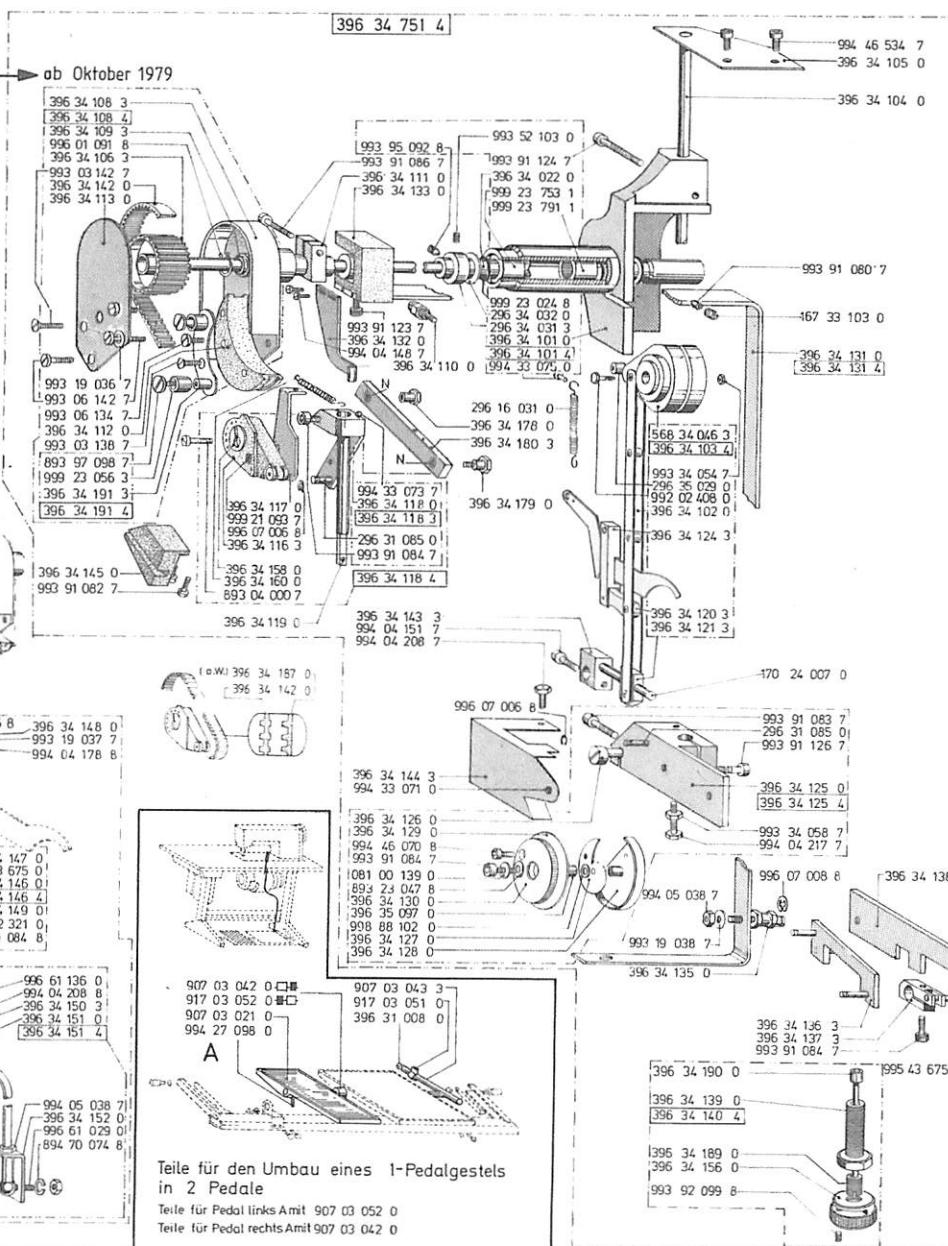
Teile für den Umbau eines 1-Pedalgestells
