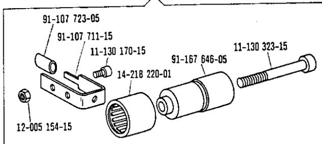
In Verbindung mit Unterklasse -913 52 (Nadelpositionier-Einrichtung)
